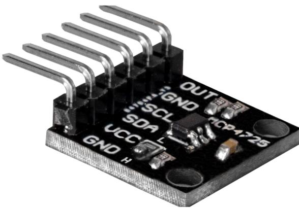
Mit diesem Digital zu Analog Wandler, können Sie mit Hilfe eines digitalen I2C-Signals, eine analoge Spannung erzeugen. Die I2C-Adresse kann durch Umsetzen einer Lötbrücke von 0x60 auf 0x61 geändert werden.
