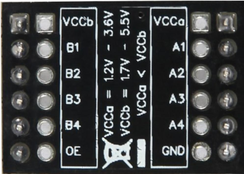
Die Signale an den Ein-/Ausgängen A1-A4, sowie B1-B4 werden auf das jeweilige Spannungslevel geschiftet (VCCa -> A1-A4 | VCCb -> B1-B4)
