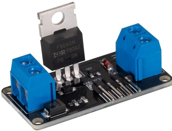
Mit dem COM-MOSFET können Sie eine Spannung von bis zu 36 Volt steuern. Mit Hilfe von Pulsweitenmodulation kann auch die Effektivspannung gesenkt werden (z. B. zum Dimmen einer LED Beleuchtung).
