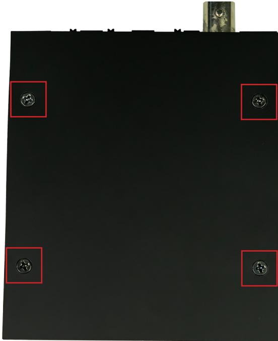
Nehmen Sie nun die Abdeckung vom Gehäuse und ziehen Sie die Hauptplatine vom Gerät ab, sodass lediglich die Display-Einheit im Gehäuse verbleibt.
