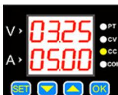
Wenn der Laststrom den gesetzten maximal Strom erreicht, dann ist der Ausgangstrom gleich wie der gesetzte Strom und das Gerät wechselt zu dem Konstantstrom, welches zur Folge hat, dass die CC-LED aufleuchtet.
