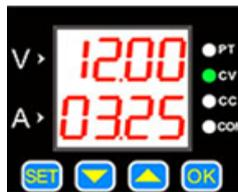
Drücken Sie „OK“ um den Ausgang an und auszu-schalten. Wenn die Laststrom unter dem gesetzten maximal Strom liegt, dann wechselt der Ausgang zum Konstantspannungsmodus und CV leuchtet auf.
