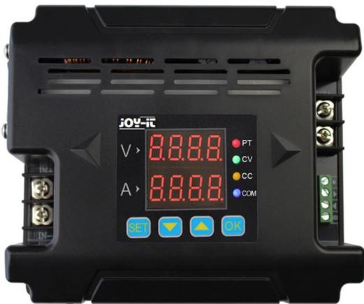
Das JT-DPM8624 ist ein programmierbares Buck-Netzteil. Dieses Netzteil hat sowohl einen konstanten Spannungs- als auch einen konstanten Strommodus. Durch die RS-485 Schnittstelle ist es auch möglich, alle Einstellungen mit einer kostenlosen Software bequem vom PC zu machen.
