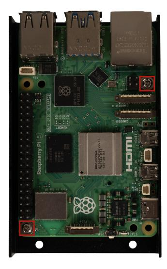
Agora, coloque os dissipadores de calor incluídos no seu Raspberry Pi. Para o fazer, retire a película adesiva das almofadas térmicas e coloque os dissipadores de calor nas seguintes posições:
