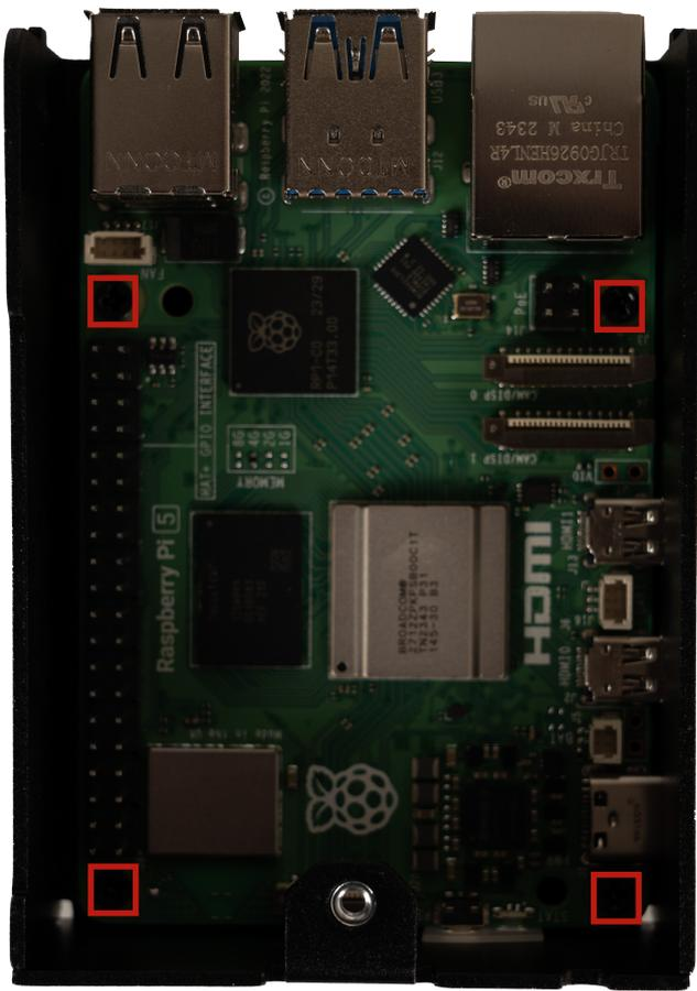
Agora, coloque os dissipadores de calor incluídos no seu Raspberry Pi. Para o fazer, retire a película adesiva das almofadas térmicas e coloque os dissipadores de calor na seguinte posição:
