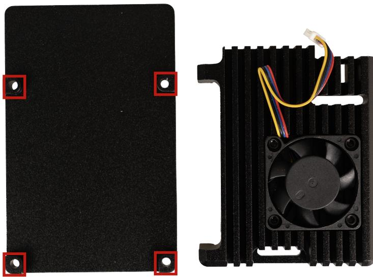
Coloque ahora las almohadillas térmicas suministradas en la parte superior de la carcasa. Para ello, retire la película adhesiva de las almohadillas térmicas y colóquelas en las siguientes posiciones:
