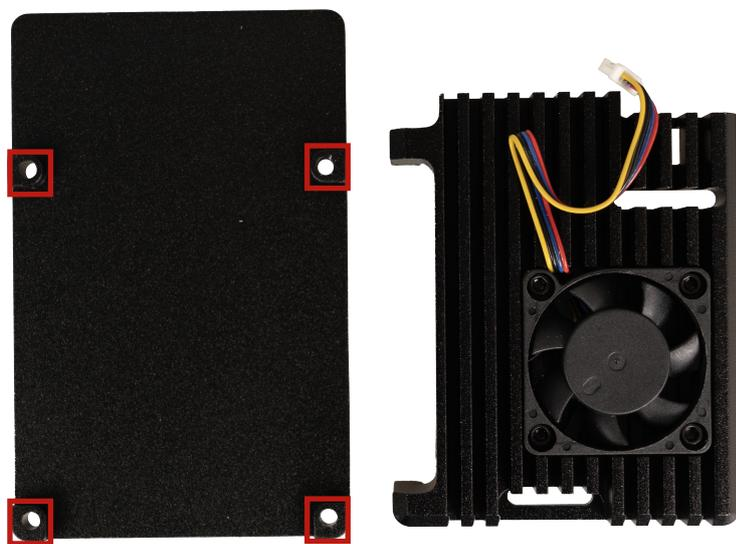
Fixez maintenant les patins thermiques fournis sur la partie supérieure du boîtier. Pour ce faire, retirez la pellicule adhésive des tampons thermiques et placez les tampons thermiques dans les positions suivantes :
