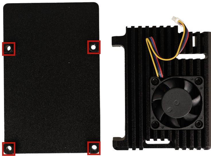
A questo punto, fissare i pad termici in dotazione alla parte superiore dell'alloggiamento. A tal fine, rimuovere la pellicola adesiva dai pad termici e posizionare i pad termici nelle seguenti posizioni:
