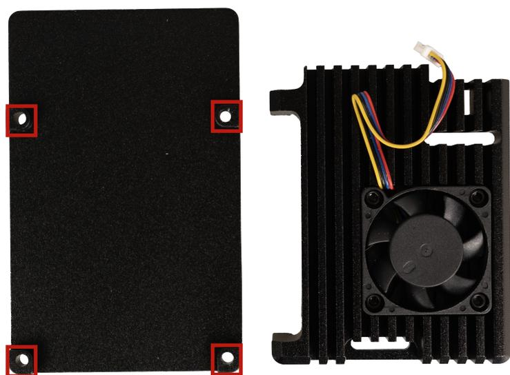
Agora, fixe as almofadas térmicas fornecidas na parte superior da caixa. Para o efeito, retire a película adesiva das almofadas térmicas e coloque-as nas seguintes posições:
