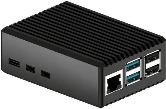
Ce boîtier en aluminium au design élégant est très robuste et protège parfaitement votre Raspberry Pi 5 contre les influences extérieures. Il dispose d'encoches pour tous les connecteurs, ce qui les rend accessibles. Le fraisage des canaux sur la partie supérieure sert de dissipateur thermique vers l'extérieur et, à l'intérieur du boîtier, des zones reposent sur le processeur et la mémoire vive afin de maximiser les résultats de refroidissement.
