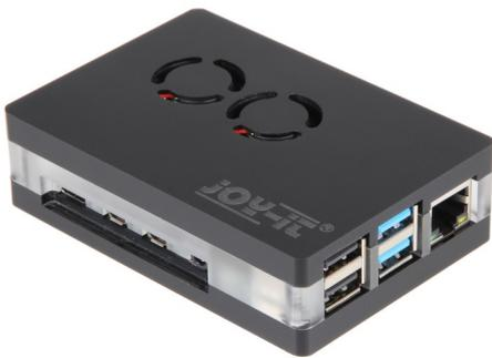
Dieses modern designte Gehäuse eignet sich gut für Ihren Raspberry Pi 4B, wenn es heiß wird. Durch den eingebauten Duallüfter bietet dieses Gehäuse Schutz vor äußeren Einwirkungen und vor übermäßiger Hitzeentwicklung.
