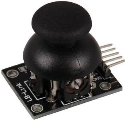
Für die Verwendung des Joysticks benötigen Sie zusätzlich den ADC. Die Anschlussbelegung können Sie der unteren Tabelle entnehmen.
