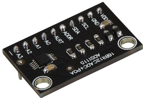
Die Pins A0 - A3 des ADCs sind die 4 analogen Eingangskanäle. So können 4 analoge Sensoren gleichzeitig betrieben werden.
