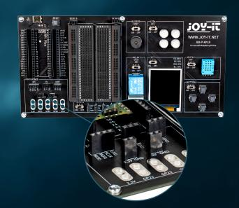
**UART (Universal Asynchronous Receiver/Transmitter):** Cette interface permet une communication série asynchrone via deux lignes : TX (Transmit) et RX (Receive). L'UART est souvent utilisée pour la communication entre les microcontrôleurs et les ordinateurs ou pour la connexion de modules tels que les récepteurs GPS ou les modules Bluetooth.
