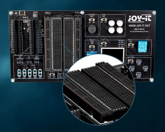
Les principaux domaines: Ils consistent en une série de rangées parallèles de trous, généralement séparées par une rainure centrale. Les trous d'une même rangée sont reliés électriquement les uns aux autres. Cette disposition est idéale pour insérer des circuits intégrés (CI) et d'autres composants.
