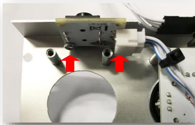
Taster mit dem 4-pol.(gekreuzt, mit Kabelbinder markiert) Kabel bestücken und mit zwei Schrauben im Gehäuse befestigen.
