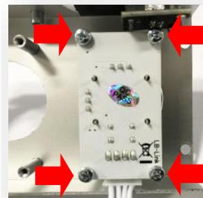
Joystick mit einem 4-pol. Kabel bestücken und unter der LED mit 4 Schrauben einbauen.
