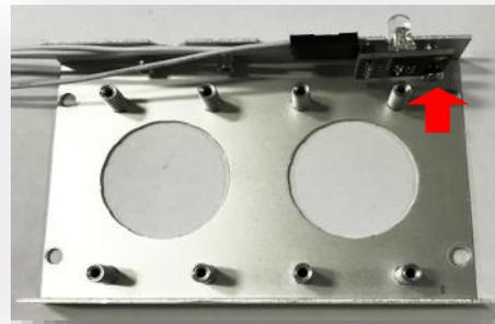
LED mit den 4 einzelnen Kabel bestücken und mit einer Schraube im Gehäuse verschrauben.
