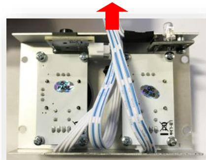
Den zweiten Joystick mit dem 4-pol. Kabel bestücken und einbauen. Nun alle Kabel durch die vorhandene Öffnung nach draußen führen und dann kann das Gehäuse verschlossen werden.
