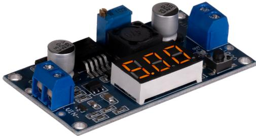
Dies ist ein Spannungswandler der auf dem DC-DC Modul LM2596S basiert. Die Spannung kann mit Hilfe des Potentiometers mit einer Genauigkeit von  $\pm 0.1$  V (DC) justiert werden. Über den Knopf kann die integrierte Segmentanzeige zusätzlich zwischen der Eingangs- und der Ausgangsspannung umgeschaltet werden.
