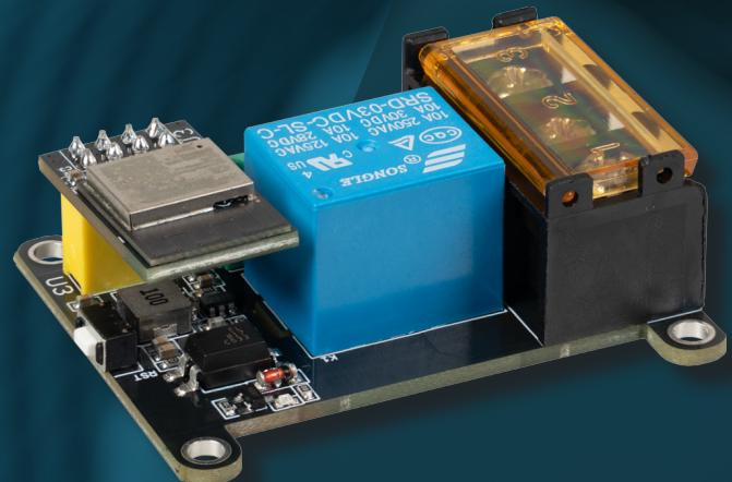
El módulo mini relé ESP32-C6 combina tecnología inalámbrica avanzada con una práctica capacidad de conmutación en un formato compacto. Equipado con el ESP32-C6-Mini-1 de Espressif, es compatible con Wi-Fi 6 (802.11ax), BT 5 LE y Zigbee / Thread, lo que ofrece una integración flexible para una amplia gama de proyectos de IoT y automatización.
