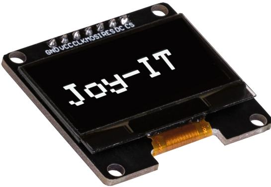
Dieses grafische 1,3“ OLED Display verfügt über eine Auflösung von 128 x 64 Pixeln und kommuniziert über die SPI-Schnittstelle. Wahlweise kann das Display auf der Rückseite auch auf die I2C-Schnittstelle umgelötet werden. Dadurch ist das Display besonders universell einsetzbar.
