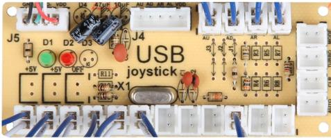
Der Zero Delay Encoder bietet auf einfachste Weise die Möglichkeit eigene Arcade-Joysticks und Buttons anzuschließen und mit dem PC oder anderen Geräten zu verbinden.
