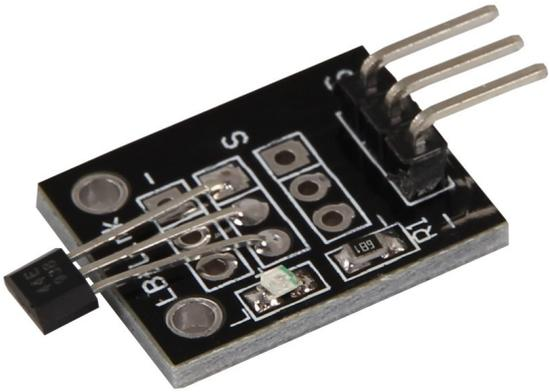
Mit diesem kleinem Hall Magnetfeldsensor, können Sie Magnetfelder mit Hilfe des Digitalen Ausgangs des Sensors und der integrierten Status LED erkennen. Wenn der Sensor in ein Magnetfeld gehalten wird, leuchtet die LED auf und der Sensorausgang wird Low gesetzt.
