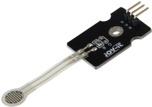
Dieser Drucksensor funktioniert mittels der analogen Erkennung von Widerstand, wenn Druck von außen auf den Sensor einwirkt, verändert sich der Widerstand und somit die Spannung des analogen Signals. Der Sensor ist hochsensibel, und der Sensorstreifen ist wasserdicht und flexibel.
