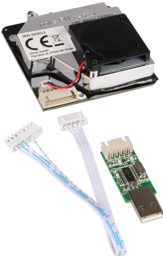
Der SDS011-Sensor ermittelt die Feinstaub-Partikelkonzentration in der Luft mit Hilfe des Streulichtverfahrens.
