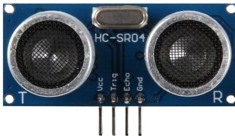
Das Ultraschallmodul arbeitet in einem Distanzrahmen von 2 bis 400 cm. Die maximale Abweichung beträgt hierbei gerade einmal 3 Millimeter. Durch die kleinen Abmessungen und hohe Verarbeitungsqualität ist dieses Modul auch ideal für mobile Einsätze geeignet.
